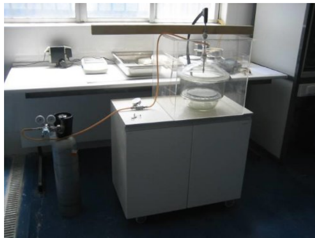
Fotografía 3: Ensayo para determinar la reducción de \text{NO}_2 .
