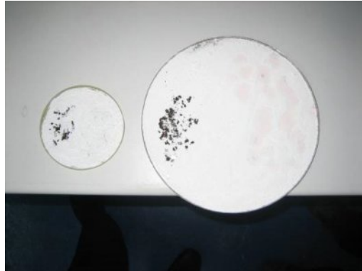
Fotografía 2: Acción fotocatalítica de los \text{TiO}_2 después de 12 horas de ensayo
